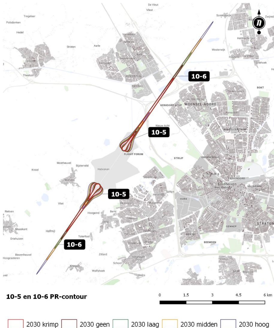
Figuur 22 – 10-5 en 10-6 plaatsgebonden risicocontouren voor de scenario's 2030 ten opzichte van de referentiesituatie (2019) – civiel verkeer.
